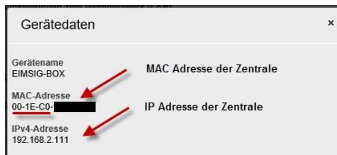
5. Nachdem die Zentrale eine IP-Adresse vom Router erhalten hat, sollten Sie diese dem EiMSIG smarthome fest zuweisen, da bei einer Änderung durch den Router kein Zugriff mehr über die App besteht.
